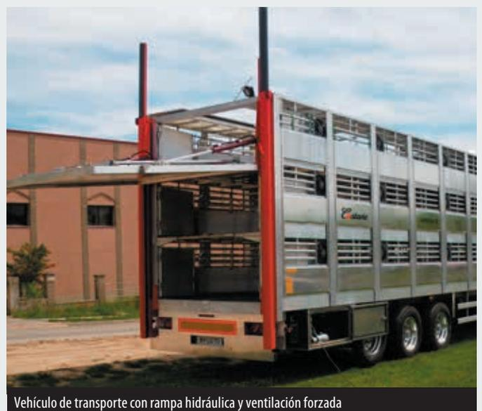
Vehículo de transporte con rampa hidráulica y ventilación forzada
