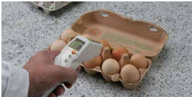
Fig. 5: Medición por infrarrojos de la temperatura superficial en alimentos
