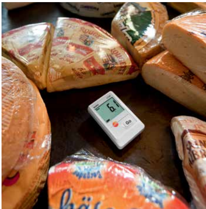
Fig. 16: Supervisión de temperatura en la sección de queso con un testo 174T
