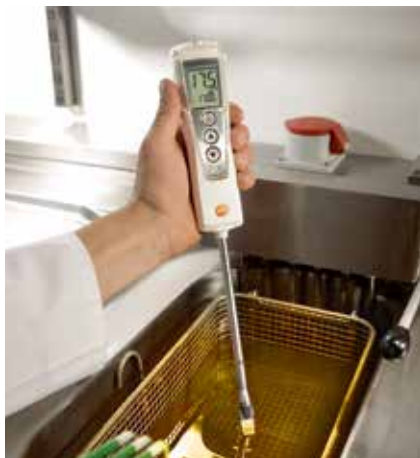
Fig. 12: Medición del valor TPM en el aceite de fritura con el testo 270
