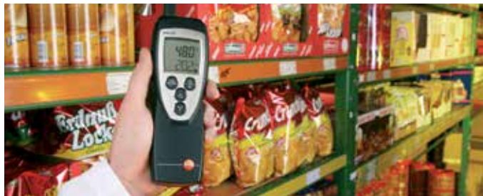
Fig. 10: Medición de humedad en la estantería del supermercado
