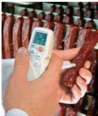
Fig. 9: Medición del valor pH en carnes y embutidos
