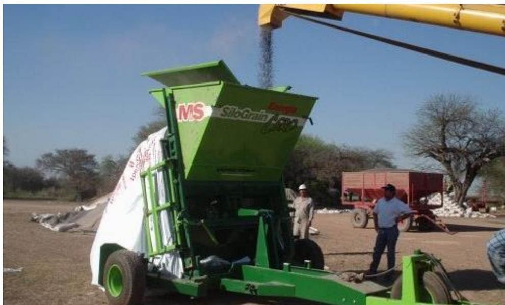
Figura 5. Embolsadora energía cero (sin sinfines) embolsando poroto con sinfín a cinta.
