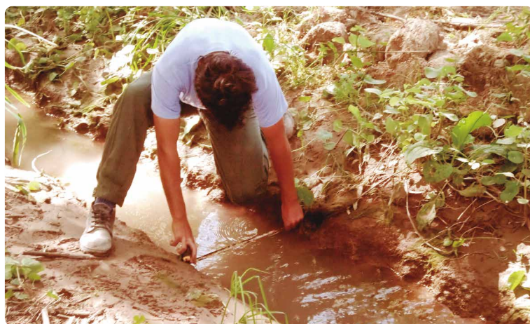
FOTO 01 Medición de sección de ramo.
