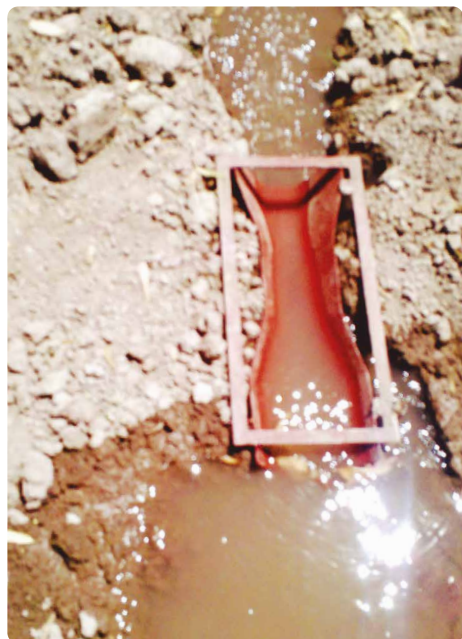
FOTO 06 Aforador para pequeños caudales.
