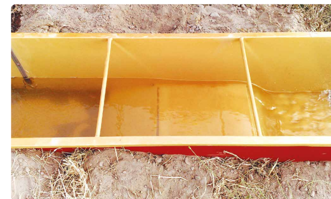
FOTO 08 Aforador cresta ancha.
