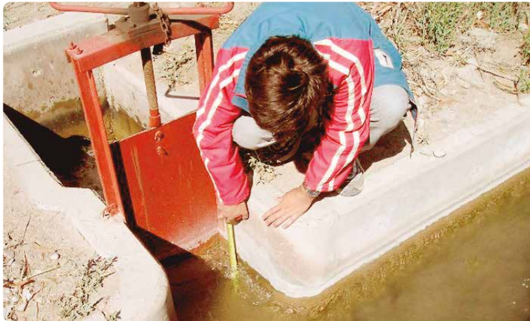
FOTO 04 Medición del nivel de agua arriba de la compuerta.
