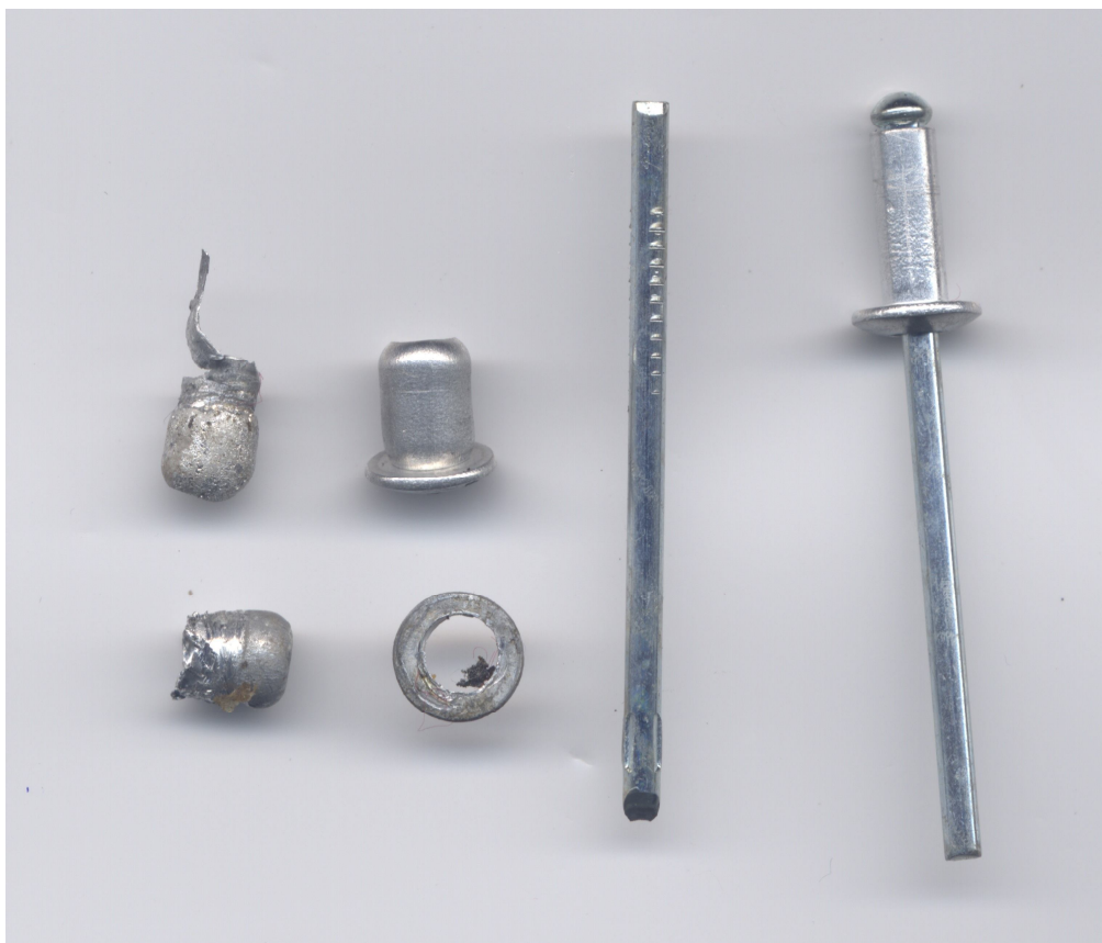
Imagen nº 3. Remache y partes residuales.
