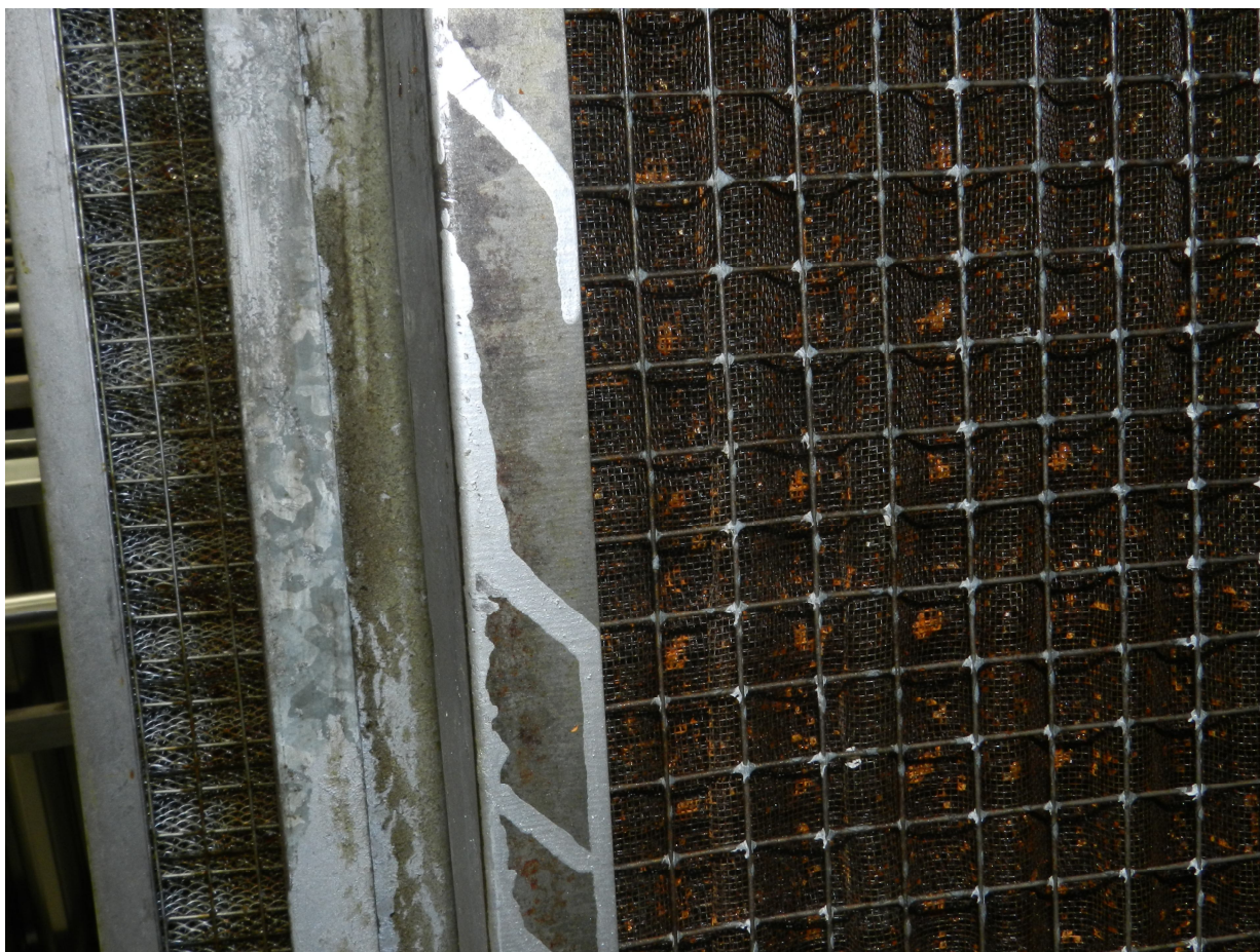
Imagen nº 11. Filtros de mallas pintados por una sola cara y por la otra sin pintar presenta puntos fuertes de oxido por un mal secado.
