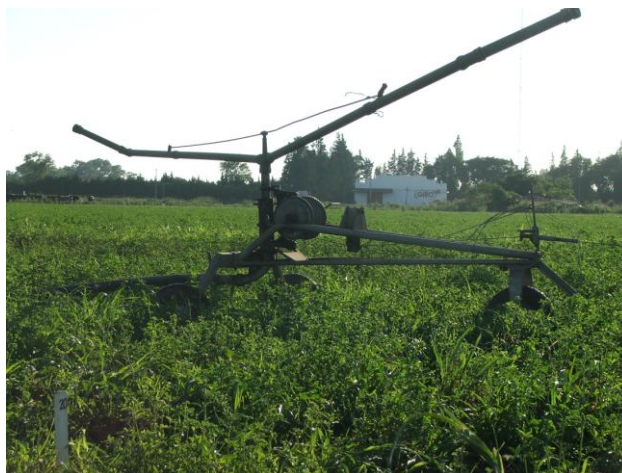
Foto 8: Sistema de riego de efluentes DeLaval Bosio.
