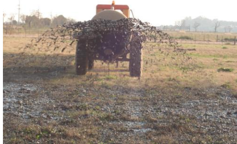
Foto 7: Distribuidor de sólidos
