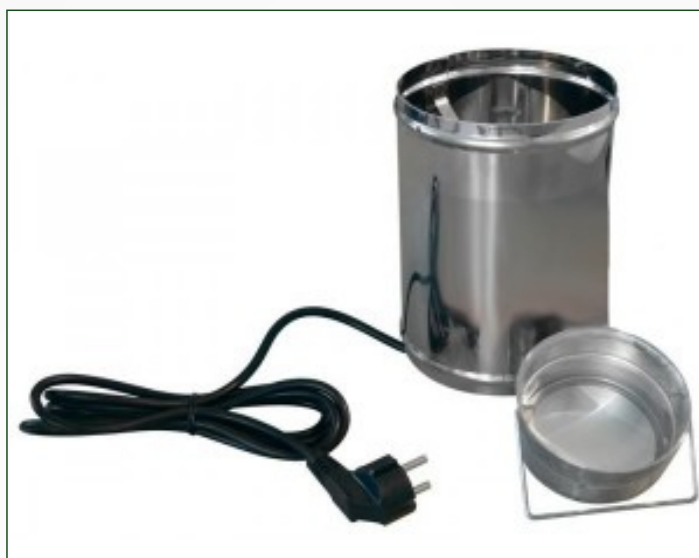
Figura 1. Sublimador de acero inoxidable.
