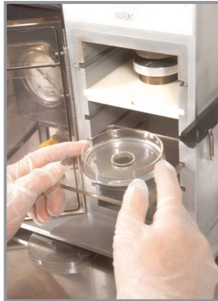
Figura 4. "Cañón" empleado para la transformación genética de plantas por bombardeo de micropartículas (biobalística).
