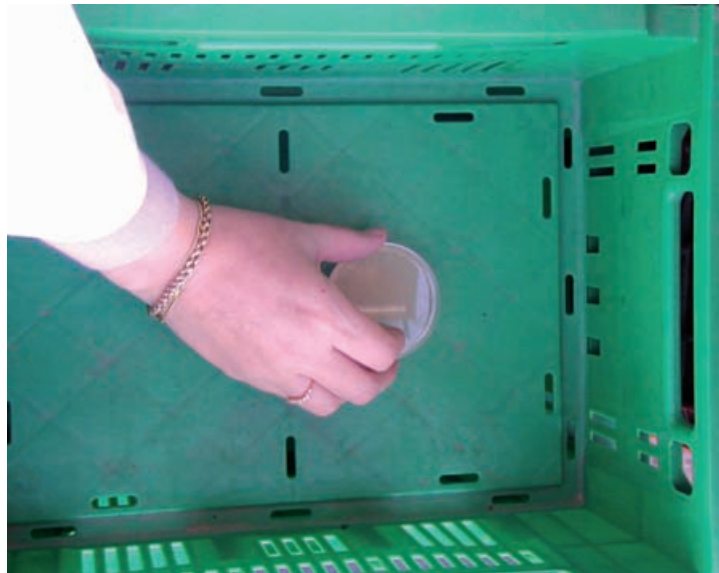
A la izquierda, placa de listeria. A la derecha, entre las técnicas para evaluar los niveles de contaminación en la superficie de las cajas destacan la inoculación por contacto utilizando placas Rodac.
